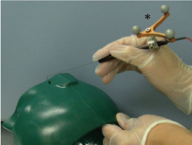
図 10. 人間用のプロトタイプの微細電極
